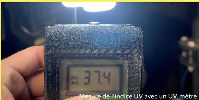
Mesure de l'indice UV avec un UV-mètre
